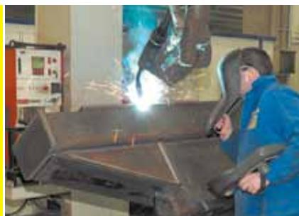
Zavarivanje korišćenjem robotske tehnologije
